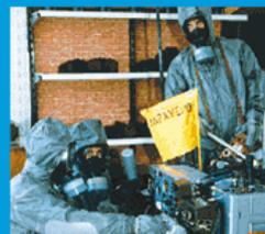
Приборы радиационной и химической разведки – устройства для обнаружения, измерения, контроля, анализа, обработки и представления информации о радиационной и химической обстановке.
